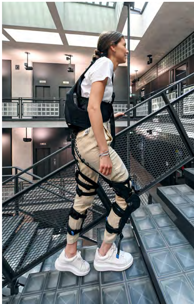
Die Biomedizintechnikerin Chiara Basla arbeitet an der Weiterentwicklung des tragbaren Exosuit, welcher den Körper beim Aufstehen, Stehen und Gehen unterstützt.
